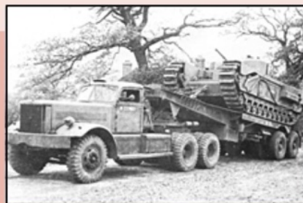
Diamond T M20, aangepast voor het gebruik van een Scammel 30-ton oplegger, die overigens met een Churchill tank redelijk was overbelast.
