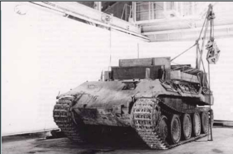
Een Panzer-Bergegerät, buitgemaakt door de Britten en gefotografeerd in een loods bij de School of Tank Technology
