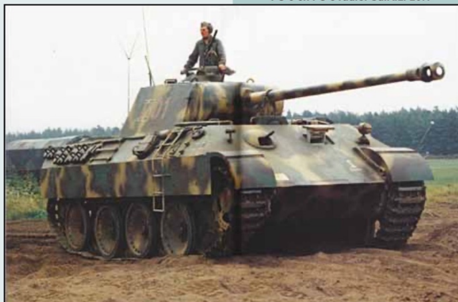
Panzerbefehlswagen Panther Ausf. A met FU 5 en FU 8 radio. Sd.Kfz. 267.
